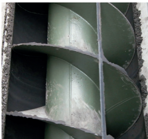
Navářená páskovina pro výškově přesnou aplikaci nanášené vrstvy při běžícím šneku
